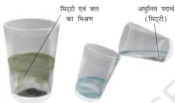
चित्र 5.8 किसी मिश्रण के दो अवयवों को अवसादन तथा निस्तारण द्वारा पृथक करना
