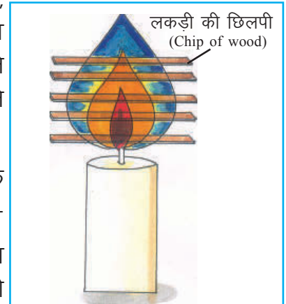
चित्र 6.6 लकड़ी की छिलपी के सहायता से ज्वाला के ताप का परीक्षण
