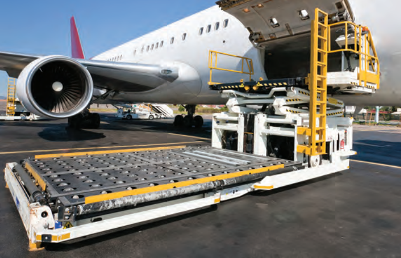
चित्र 7.15 — विमान में माल लादने के लिए प्रयुक्त मशीनें
