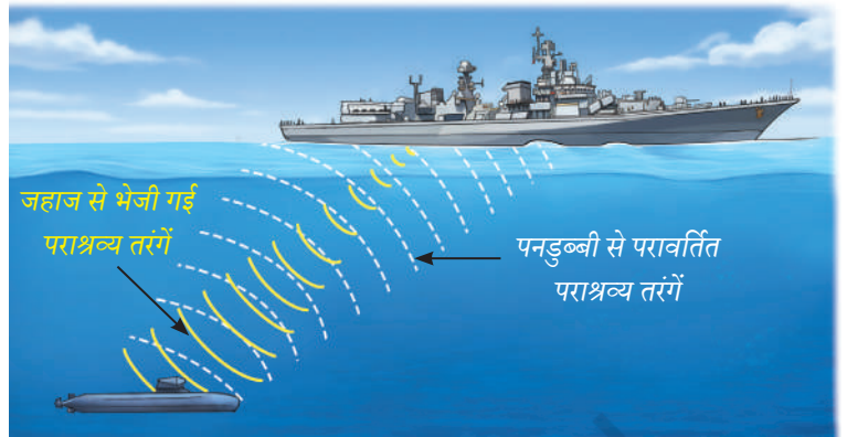
चित्र 10.28 — सोनार की कार्यप्रणाली
